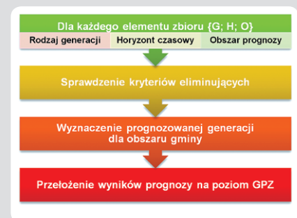
Rys. 1. Schemat algorytmu prognozowania generacji
