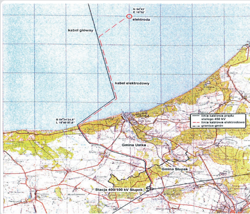
Rys. 3. Trasa linii kablowej przy polskim brzegu [1]
