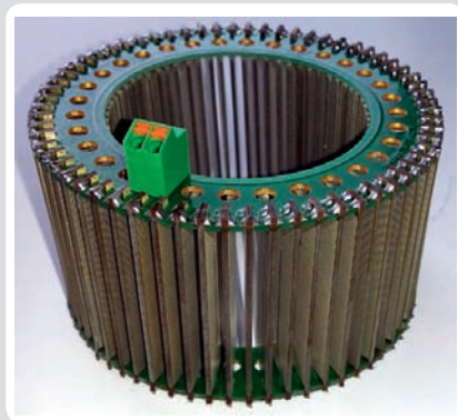
Fot. 1. Konstrukcja bezrdzeniowego przetwornika wykonanego w technologii PCB
