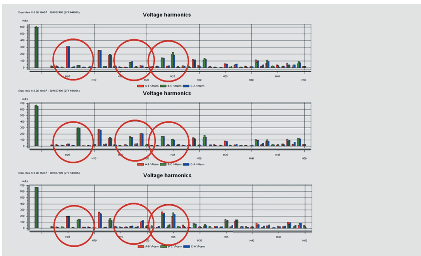
Rys. 3. Rysunek obrazuje przykładową zmienność widma WH napięcia, zależną od kąta wysterowania 6-pulsowego przekształtnika tyrystorowego
