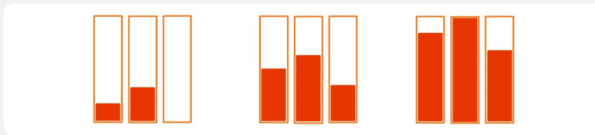
Rys. 3. Ograniczenie pojemności baterii poprzez brak balansowania SoC ogniw
